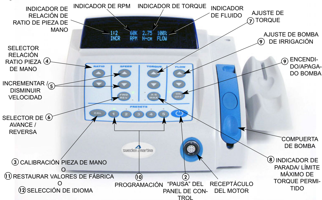
Fig. 6 - PANEL DE CONTROL DE LA CONSOLA
